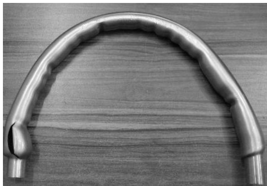
شکل ۹- قطعه شکل داده شده در مرحله بالج در فشار ۹۲ MPA به دست آمده از آزمایش تجربی
