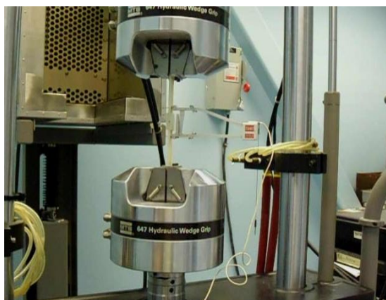
شکل ۳- تجهیزات آزمایش کشش و بارگذاری سیکلی
