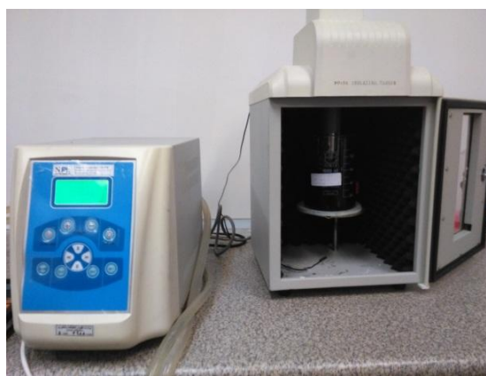
شکل ۴- دستگاه همزن آلتراسونیک استفاده شده در این آزمایش
