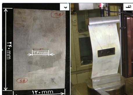
شکل ۷- الف) نمونه تحت بارگذاری و ب) ابعاد و هندسه ورق و شکاف
