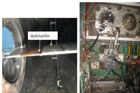
شکل ۲- مدل ایرفویل نصب شده در محفظه آزمون و سیستم نوسان ساز هیدرولیکی پیچ
