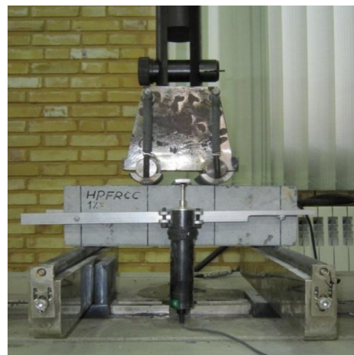
شکل ۴- هندسه نمونه‌ها و چیدمان آزمایش مقاومت خمشی
