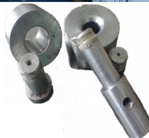
شکل ۱۲- پرس هیدرولیکی و اجزای قالب هیدروفرمینگ
