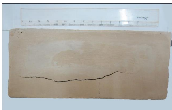
شکل ۸- نمونه ترک در یک خشت از خاک رس با ابعاد واقعی 112 \times 186 میلی‌متر
