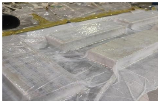
شکل ۴- قرار گرفتن نمونه‌ها تحت خلأ
