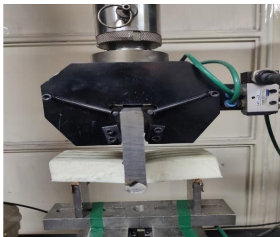
شکل ۵- نمونه در حال آزمایش خمش سه نقطه
