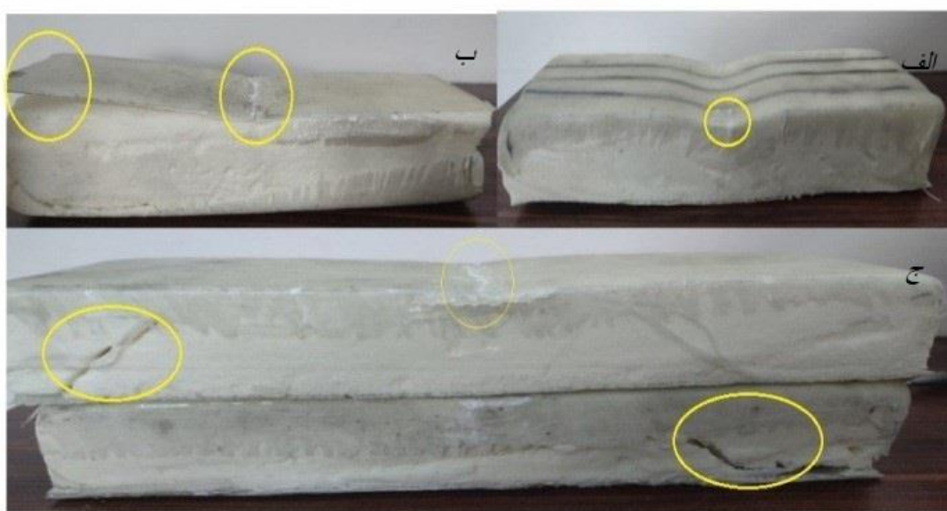
شکل ۱۸- حالت و محل تخریب نمونه‌ها ساندویچی پس از آزمایش خمش الف) شکست نمونه تقویت‌شده پس از آزمون خمش ب و ج) شکست نمونه تقویت نشده و بدون سیم
