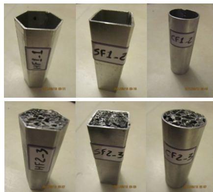
شکل ۴- برخی از نمونه‌های ساخته شده (بالا: لوله‌های توخالی، پایین: لوله‌های پر شده از فوم)
