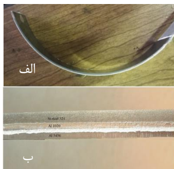
شکل ۲- نمونه‌های ورق سه‌لایه فلزی تولیدشده به روش
