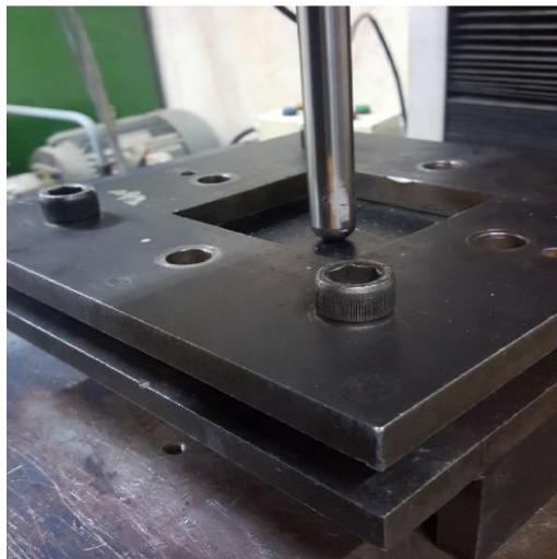
شکل ۹- نفوذ کننده نیمه کروی به قطر ۲۰ میلی متر و قید و بند نگه دارنده کامپوزیت
