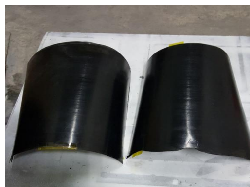
شکل ۲- کامپوزیت تولید شده با روش پرس گرم در دمای ۲۵۰ درجه
