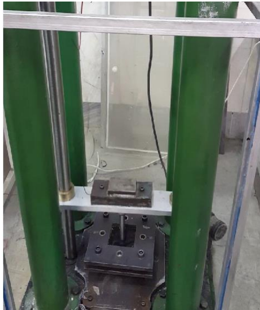
شکل ۱۱- انجام آزمون سقوط وزنه بر روی ورق کامپوزیتی
