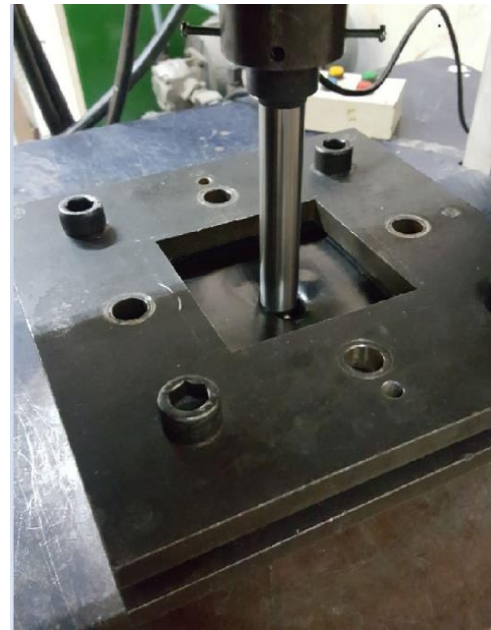
شکل ۱۰- انجام آزمون نفوذ شبه استاتیک و نفوذ به ورق کامپوزیتی
