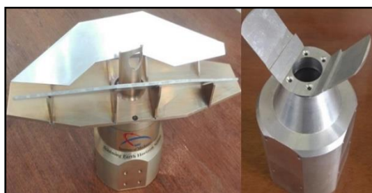
شکل ۲- نمایی از حسگر افق زمین ساخته شده در پژوهشکده مکانیک شیراز [۷]
