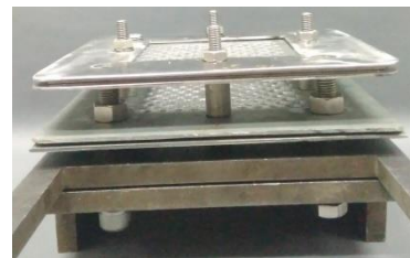
شکل ۶ - چیدمان مجموعه صفحه‌های هدف (صفحه پایه + صفحه‌های سوراخ‌دار جلویی و پشتی)
