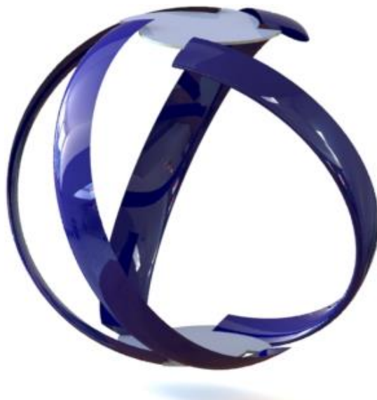
شکل ۳- نمای توربین کروی لوسید با طول وتر پره ۱۶ سانتی‌متری طراحی شده با ایرفویل ناکا ۰۰۲۰ و تعداد ۴ پره، در نرم افزار سالیدورک
