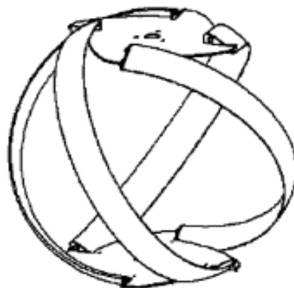
شکل ۹- مدل هندسی توربین کروی لوسید با ایرفویل ناکا ۰۰۲۰ و تعداد چهار پره متقارن مورد استفاده در آزمایش تجربی باچانت و وزنیک [۱۳]
