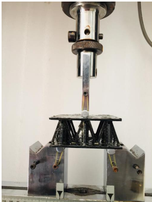
شکل ۶- ساندویچ پانل با هسته M شکل تحت بارگذاری خمش سه نقطه‌ای
