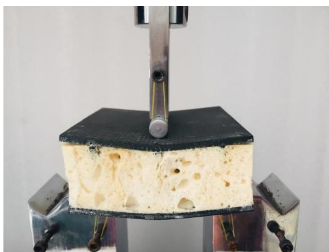
شکل ۱۳- ساندویچ پانل پر از فوم تحت آزمون خمش سه نقطه‌ای
