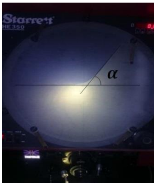
شکل ۱۴- اندازه‌گیری با دستگاه پروفایل پروژکتور
