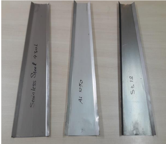
شکل ۱۳- نمایی از ورق‌ها با جنس‌های مختلف پس از انجام آزمایش‌های تجربی
