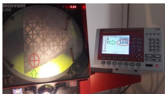
شکل ۹- اندازه‌گیری ضرایب ناهمسانگردی به وسیله دستگاه پروفایل پروژکتور
