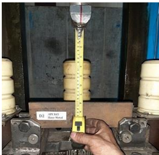
شکل ۲- تصویر نمونه فولادی قرار گرفته زیر چکش
