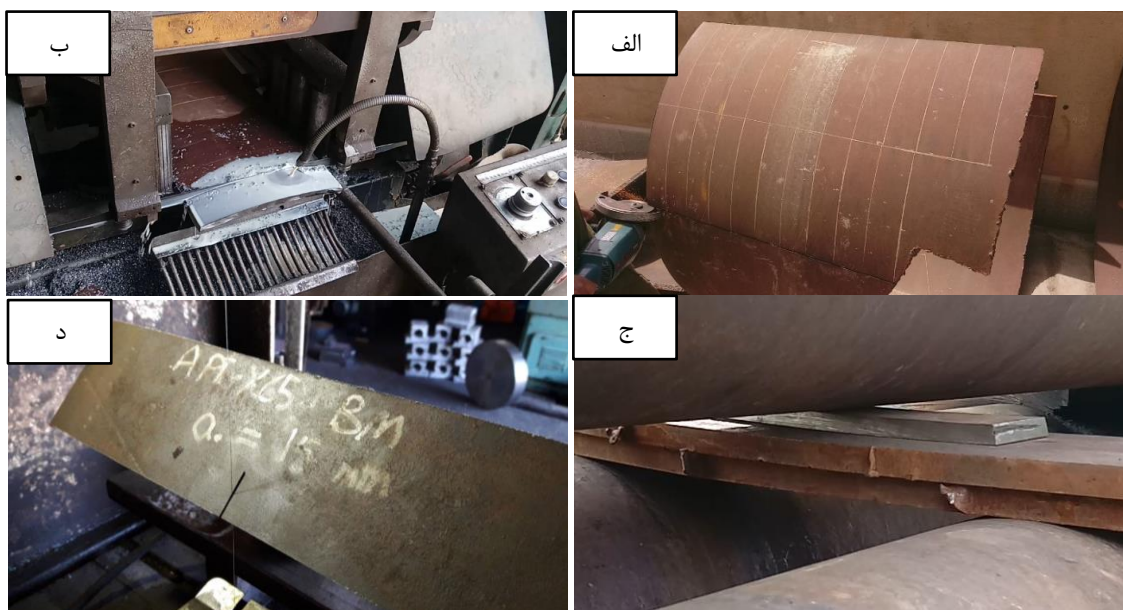
شکل ۵- مراحل آماده‌سازی نمونه؛ الف) برش اولیه از لوله، ب) رساندن نمونه به ابعاد استاندارد، ج) مسطح سازی و د) ایجاد شیار
