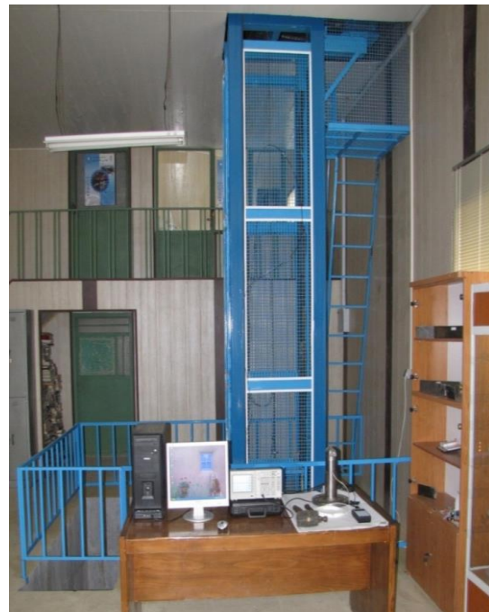
شکل ۳- دستگاه ضربه سقوطی استفاده شده در تحقیق حاضر
