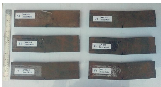
شکل ۸- تصویر تعدادی از نمونه‌ها پس از اعمال ضربه کم سرعت
