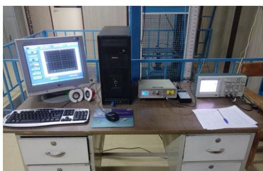
شکل ۷- نمایش تجهیزات متصل به دستگاه ضربه سقوطی جهت ثبت نتایج شتاب سنج و کرنش سنج
