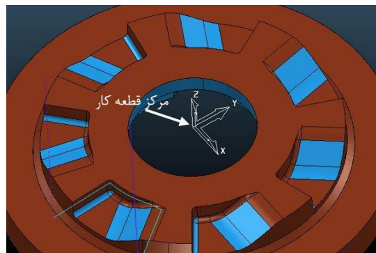
شکل ۱۰- نمایش محل نقطه صفر در پوش در محیط نرم‌افزار پاورمیل مورد استفاده
