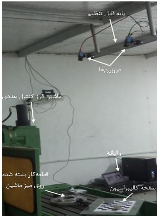
شکل ۴- چیدمان دوربین‌ها و سایر تجهیزات در محیط کارگاه
