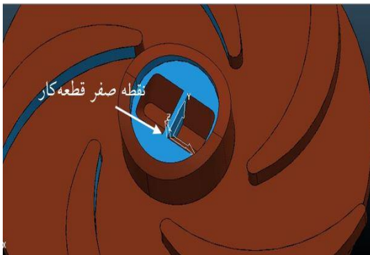
شکل ۱۶- محل در نظر گرفته شده به عنوان نقطه صفر پره پمپ ریخته‌گری شده
