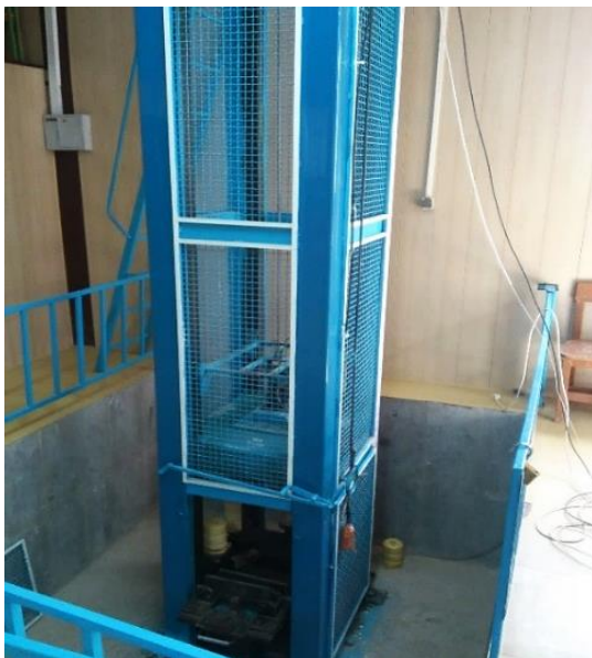
شکل ۳- دستگاه آزمایش ضربه سقوطی استفاده شده در تحقیق حاضر
