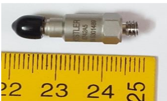
شکل ۴- شتاب‌سنج کیستلر نصب شده روی چکش دستگاه
