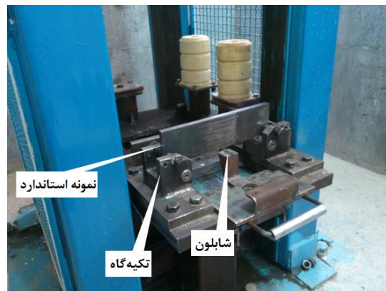
شکل ۵- قرار گرفتن نمونه روی تکیه‌گاه در دستگاه آزمایش ضربه سقوطی
