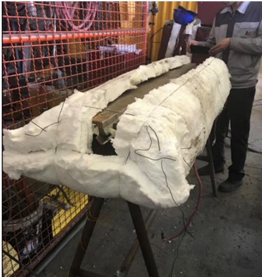
شکل ۲- قطعه آماده شده برای جوشکاری پس از قرار دادن المنت‌ها و عایق‌بندی
