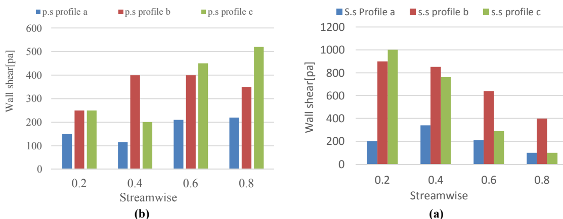
شکل ۱۴- مقایسه نیروی برشی دیواره (a) در سمت مکشی و (b) در سمت فشاری در پروفیل‌های مختلف
