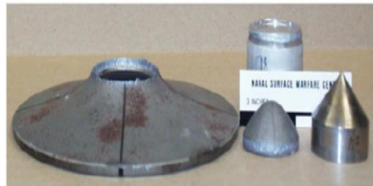
شکل ۸- مقایسه حالت شکست پتالینگ در ورق با نتایج آزمایشگاهی [۶] در مقابل پرتابه مخروطی با سرعت ۳۳۵ متر بر ثانیه
