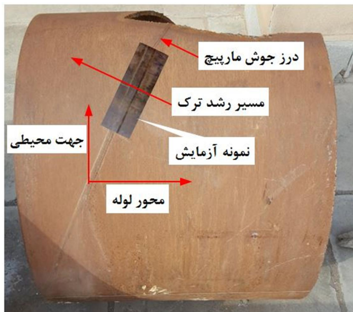
شکل ۴- لوله‌ی API X65 با درز جوش ماریپیچ و نمونه آزمایشگاهی جدا شده از آن
