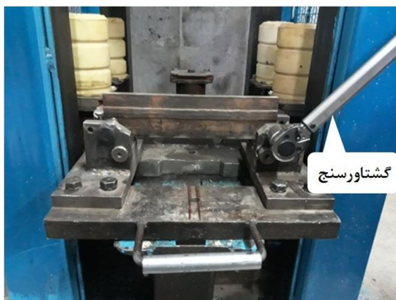
شکل ۸- بستن پیچ‌های نمونه آزمایش در گیره دستگاه با کمک گشتاورسنج
