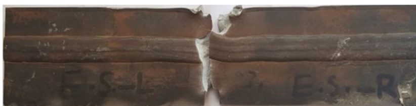
شکل ۹- مسیر رشد ترک در نمونه آزمایش
