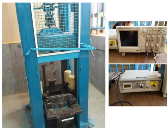
شکل ۷- دستگاه آزمایش ضربه سقوطی با ظرفیت ۳۰۰۰۰ ژول
