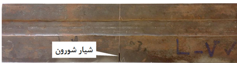
شکل ۶- شیار شورون به عمق ۵/۱ میلی‌متر در وسط نمونه آزمایش ضربه سقوطی
