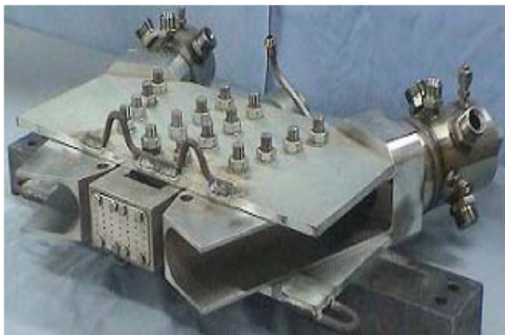
شکل ۳- مدل شیپوره آبرواسپایک با زاویه‌ی متغیر نازل [۱۵]
