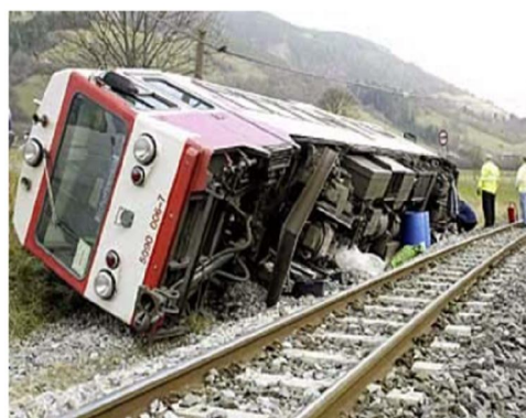
شکل ۱- واژگونی قطار ناشی از وزش باد عرضی در اتریش،
