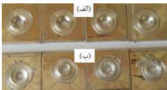
شکل ۱۱- نمایی از سطح بالایی کیفیت اتصال برای تعدادی از آزمایش‌ها الف) ۷۰۷۵-T۶ ورق زیرین اتصال و ب) ۷۰۷۵-T۶ ورق رویی اتصال
