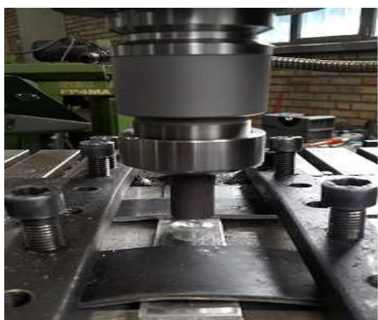
شکل ۴- نحوه جوش دو قطعه آلومینیوم غیر همنام
