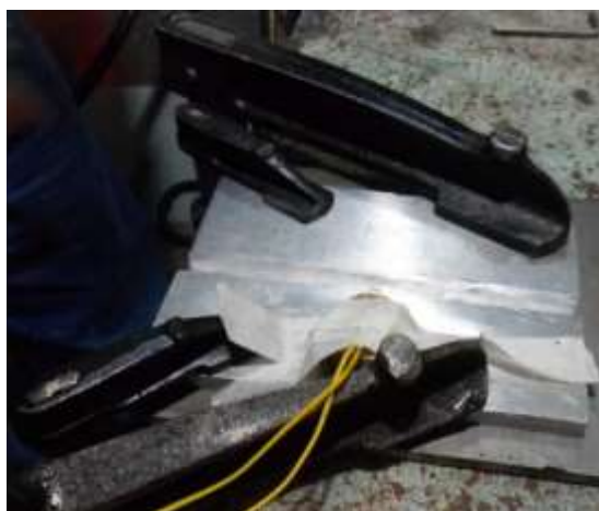
شکل ۱- تصویری از ابعاد ورق‌های آماده شده و محل نصب ترموکوپل‌ها
