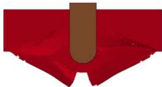
شکل ۱۱- پیش‌بینی نامناسب حالت شکست فوم
