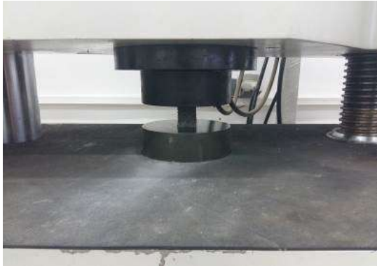
شکل ۴- نمونه فوم کامپوزیتی A356/SiC p تحت آزمایش فشار
