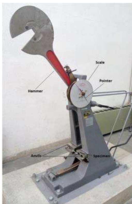
شکل ۴- تصویری از انجام آزمون ضربه توسط ماشین آونگی توریسی
