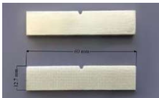
شکل ۳- نمونه‌های آزمون ضربه چارپی ساخته شده از چندلایه الیافی فلزی و کامپوزیت الیاف شیشه/اپوکسی
