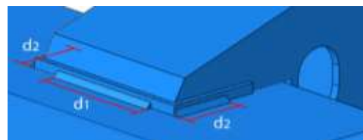
شکل ۱۶- اندازه طول خط جوش ها ( d_1 و d_2 )
