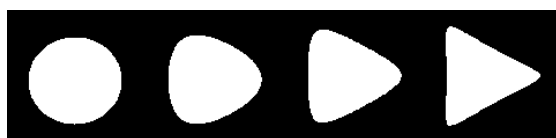
شکل ۳- تأثیر پارامتر m بر گوشه‌های گشودگی مثلثی
