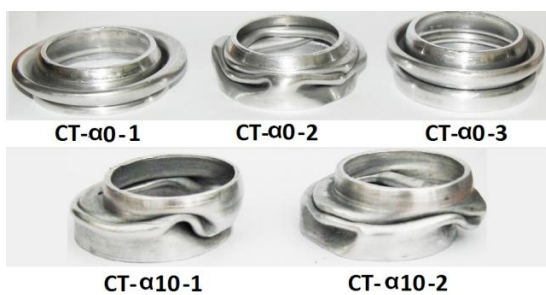
شکل ۵- فروریزش نهایی پوسته‌های مخروطی بدون فوم تحت بارگذاری محوری و مایل
