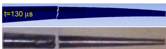
شکل ۱۸- مقایسه مکان شکست پرتابه حاصل از نتایج آزمایشگاهی [۱۶] و شبیه‌سازی عددی
