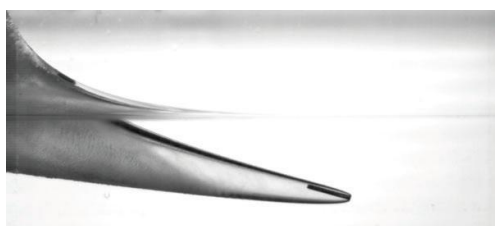
شکل ۲- برخورد پرتابه با سطح آب و تشکیل حفره کپسولی و پیوسته [۲]
