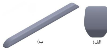
شکل ۲- نمایی از هندسه مدل‌سازی شده در سالدورک (الف) سطح مقطع مدل و (ب) مدل سه بعدی
