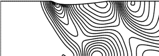
شکل ۲۱- کانتور فشار جیمسون
