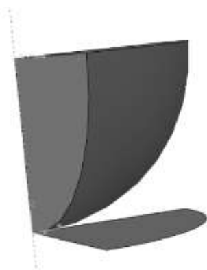
شکل ۱۰- موقعیت قرار گرفتن ورق زیر پانچ در شکل‌دهی ورق به روی پانچ
