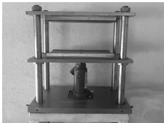
شکل ۱- پرس هیدرولیکی گرم ساخته شده
