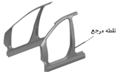
شکل ۲۴- نقطه مرجع بر روی ستون میانی برای اندازه‌گیری پارامترها
