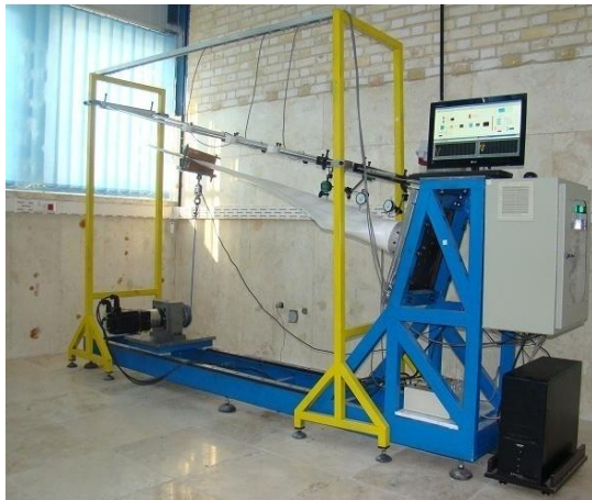
شکل ۱- دستگاه آزمون پره توربین بادی کوچک
