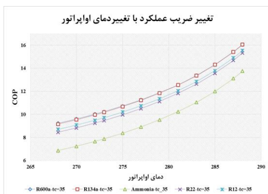
شکل ۵- تأثیر تغییر ضریب عملکرد با تغییر دمای اواپراتور برای مبردهای مختلف و دمای کندانسور ۳۵ درجه سانتی‌گراد
