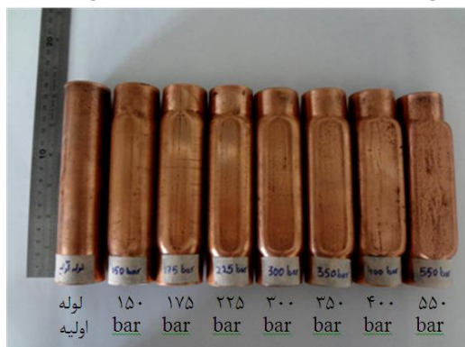
شکل ۱۰- قطعات نهایی هیدروفرم شده با فشارهای مختلف
