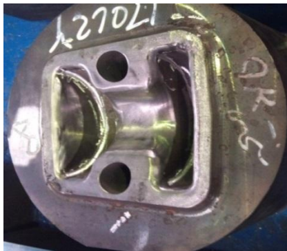
شکل ۱۱- قالب پیش‌فرم تراشیده شده بعد از بهینه‌سازی
