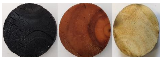
شکل ۱- فرآوری چوب کاج، از راست به چپ: چوب طبیعی، پس از لیگنین زدایی، پس از عملیات حرارتی
