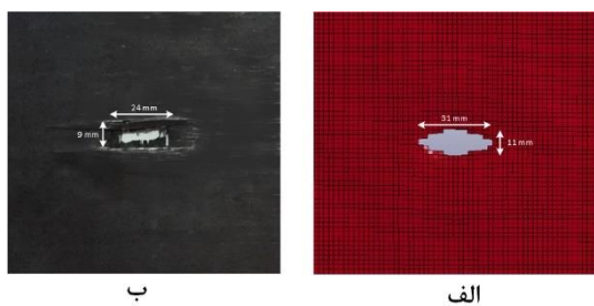
شکل ۱۴- مقایسه نحوه و میزان تخریب ایجاد شده در صفحه کامپوزیتی بر اساس (الف) شبیه سازی عددی و (ب) تست تجربی
