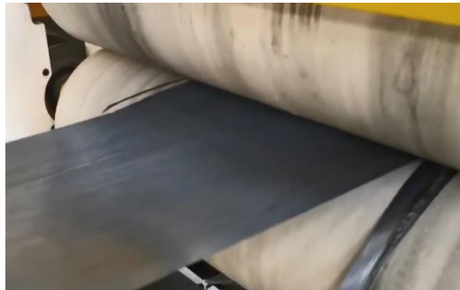
(ب) ترکیب نهایی پیش آغشته بعد از پرس بین دو غلتک شکل ۲- نحوه آغشته سازی الیاف کربن و ماده زمینه پلی فنیلن سولفاید
