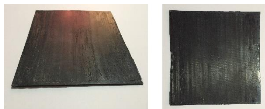
شکل ۵- کامپوزیت ترموپلاستیک چهار لایه ساخته شده بعد از پرس گرم
