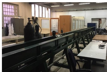
شکل ۸- دستگاه اسلحه گازی استفاده شده
