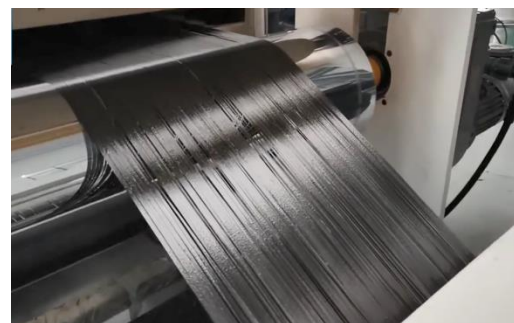
(الف) آغشته شدن الیاف کربن به پلی فنیلن سولفاید
