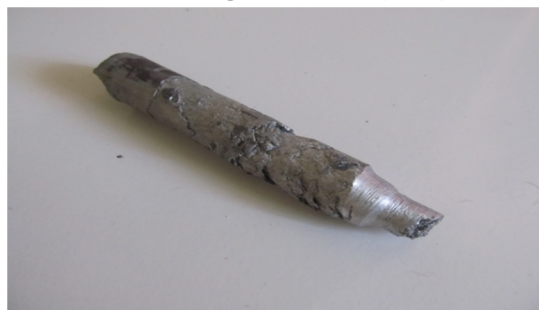
شکل 3- نمونه اکستروژن شده در دمای نیمه‌جامد بدون عملیات حرارتی محلول‌سازی (عیب درخت کاجی)
