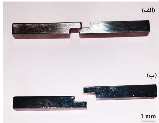
شکل ۳- نمونه‌های آزمون کشش: (الف) قبل از آزمون (ب) بعد از آزمون
