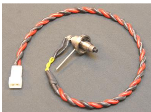
شکل ۱۱- یک نمونه آتش‌زنی میله گداخته مورد استفاده در موتورهای میکروتوربوجت [۵۲]
