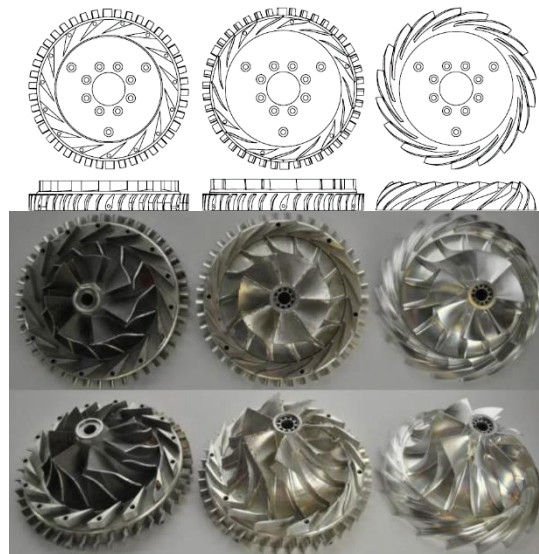
شکل ۷- چند نمونه پخش‌کن در کمپرسور شعاعی [۴۶]
