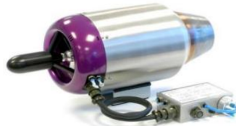
شکل ۱۶- مجموعه یکپارچه از اجزاء جانبی و نحوه اتصال آن به موتور ۵۲]
