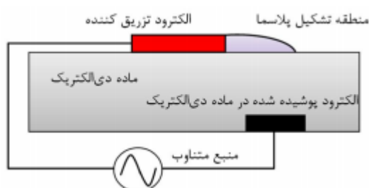
شکل ۱- طرح‌واره عملگر تخلیه سد دی‌الکتریکی به همراه اثر آن روی جریان [۲]
