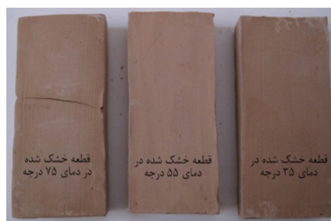
شکل ۵- تصاویر قطعات خشک شده در دماهای مختلف
