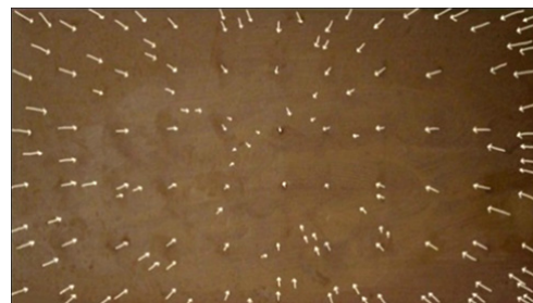
شکل ۹- بردارهای کرنش ناشی از آزمایشات در انتهای زمان خشک شدن بر روی قطعه خام در دمای ۵۵ درجه
