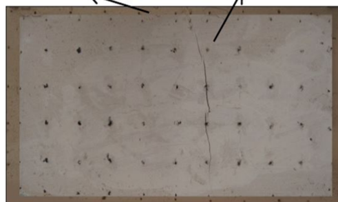
شکل ۸- تغییر شکل قطعه در انتهای فرایند خشک شدن نمونه در دمای ۵۵ درجه
